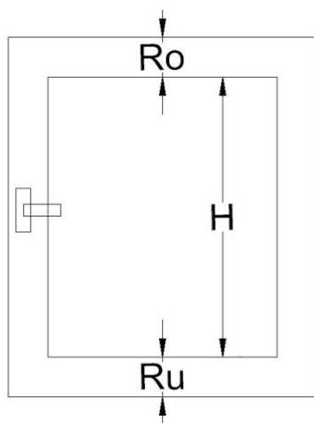
Aufmaßblatt zur Bestimmung der Elementbreite und der Auszugslängen für ah-rol® Lichtfilteranlagen.
